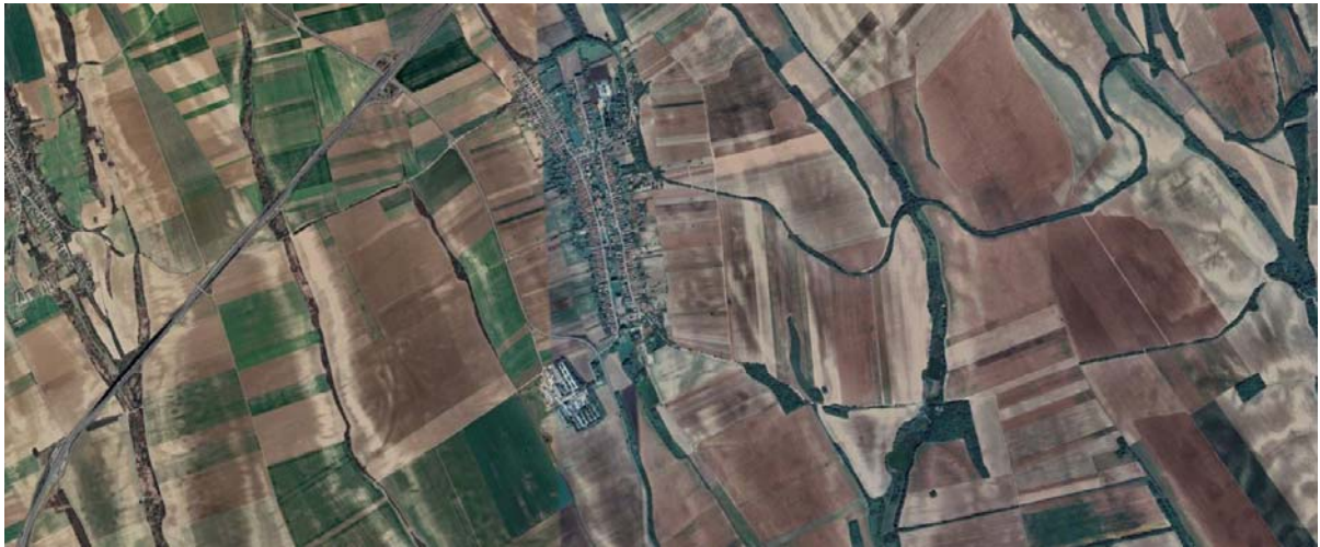
Vízerózió nyomai láthatóak az űrfelvételen a vízfolyások menti keleti és nyugati irányú, 5-10%-os lejtőkön
